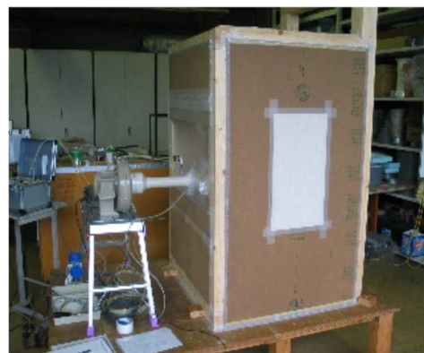
▲気密部材の性能試験
