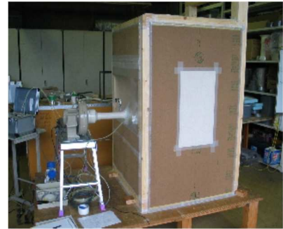
・気密部材の性能試験
