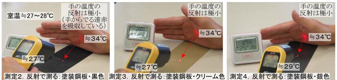
補足. 放射温度計の放射率設定値 = 0.95 (木・塗装・紙程度)。写真中の赤色光は測定位置指示用レーザー光です。注意. 近距離測定の場合、レーザー光のあたる位置と測定範囲が少しずれます(レーザー照射部が測定部の下にあるため)。注意. 試す場合は、レーザー光を人の目に向けないでください。レーザー光が目に入ると目に障害を及ぼすことがあります。
