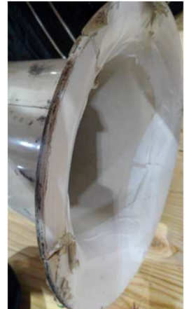
●長年よく働いた旧型ドクタードルフィン (ヤマイチ(株)使用品、FRPに割れ・欠け)
