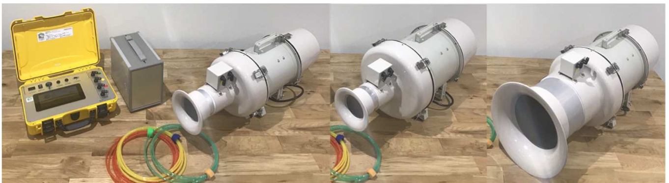
●開発した小型気密測定器Dolphin-Air (ファン羽根径 \phi 200+整流筒 \phi 94mm)
