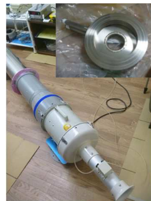
●左：流量試験(基準：絞り機構のオリフィス) ●右：総相当隙間面積 \alpha Aテスト(丸穴開口)
