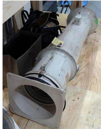
●長年よく働いた旧型ドクタードルフィン (ヤマイチ(株)使用品、FRPに割れ・欠け)
