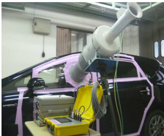
●左：自動車の気密測定（新型特注・JIS対応高精度タイプ）
