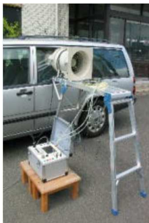
●左：自動車の気密測定（新型特注・JIS対応高精度タイプ）
