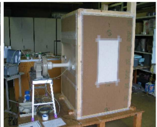
●右：壁パネル模型の気密測定
