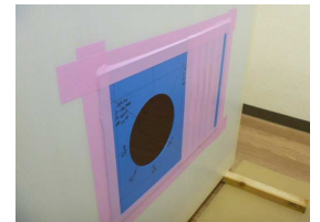
●左：流量試験(基準：絞り機構のオリフィス) ●右：総相当隙間面積 \alpha Aテスト(丸穴開口)
