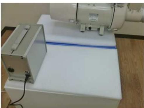
③ プラダン箱の底にある緩衝材をプラダン箱の上に敷き、箱のふたを押さえる。
