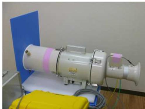
② 開口部ダクトと吹出ダクトの差し込む部分をテープ貼りで十分に気密・補強する。
