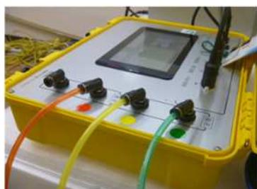
⑱ コントローラに圧力チューブを接続する。
