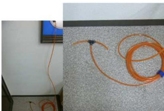
⑯ 外気用圧力チューブの先端(T字管)は屋外の風の影響を受けにくいところに置く。
