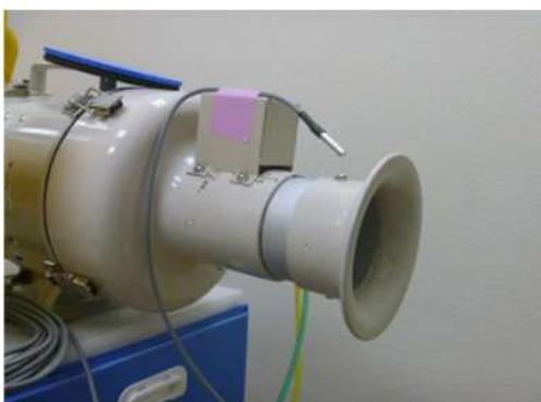
㉒ 室温センサーは空気吸込み付近または室内の中央(床から高さ1.2m程度)に置く。
