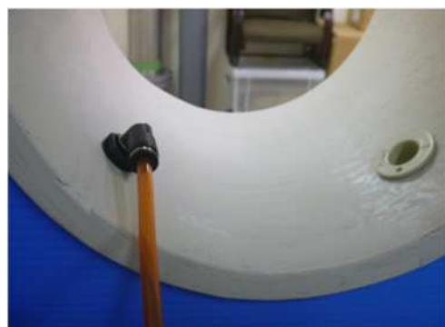
⑮ 同コネクタの外側に外気用圧力チューブを接続する。
