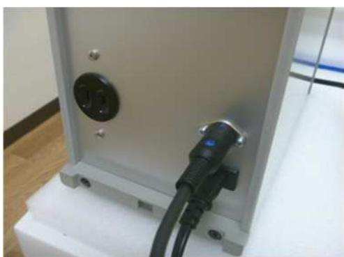
⑤ インバーターボックスの(下)電源と(上)ファン信号ケーブルを接続する。
