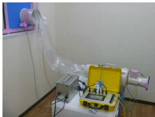
① ビニールダクト(標準長さ2.5m)を延ばして、ファン側に差し込み、テープ貼りで止める。
