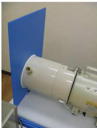
① 開口部ダクトを吹出ダクトに直接差し込む。
