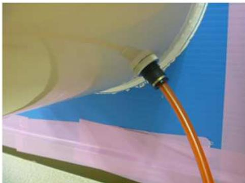
⑭ 同コネクタに外気用圧力チューブを接続する。
