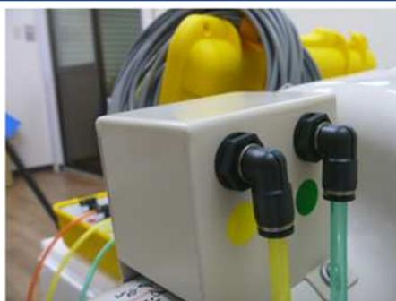
⑰ 整流筒に圧力チューブを接続する。
