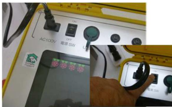
⑪ コントローラの電源スイッチをONにする。起動画面の1分程度待つと測定画面になる。
